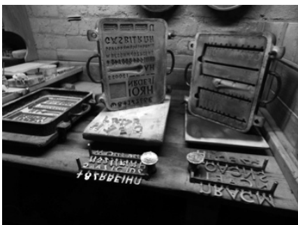
Sandformen zur Herstellung von Buchstaben in der Gießerei Bronzen- Gunkel GmbH
